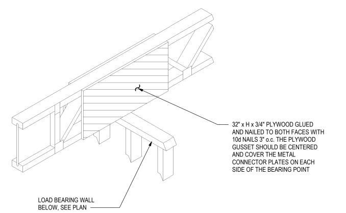
TRIM JOIST CANTILEVER DETAIL
