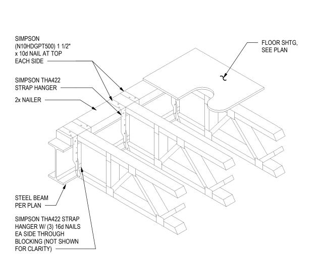
BEAM TO DOUBLE TRIM JOIST BEAM
