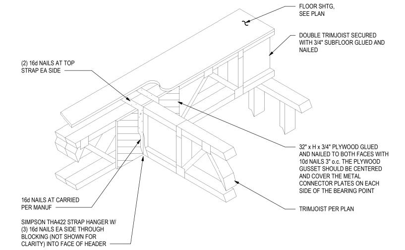
TRIM JOIST TO DOUBLE TRIM JOIST BEAM S5.4 3/4" = 1'-0"
